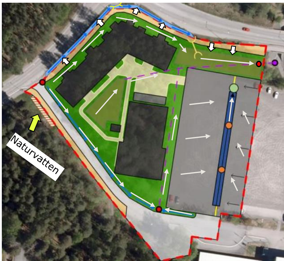
Figur 13. Övre bild. Översiktliga förslag till principlösning för dagvattenhanteringen inom utredningsområdet. Nedre bild. Inzoomad bild av utredningsområdets föreslagna anläggningar samt önskvärd höjdsättning/flödesriktningar.
