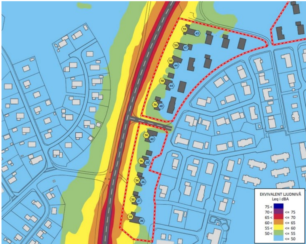
Figur 11. Ekvivalent ljudnivå. Ljudutbredning på 1,5 m höjd och högsta ljudnivå vid fasad (siffrvärdena). Utan bullerskyddsskärm.
