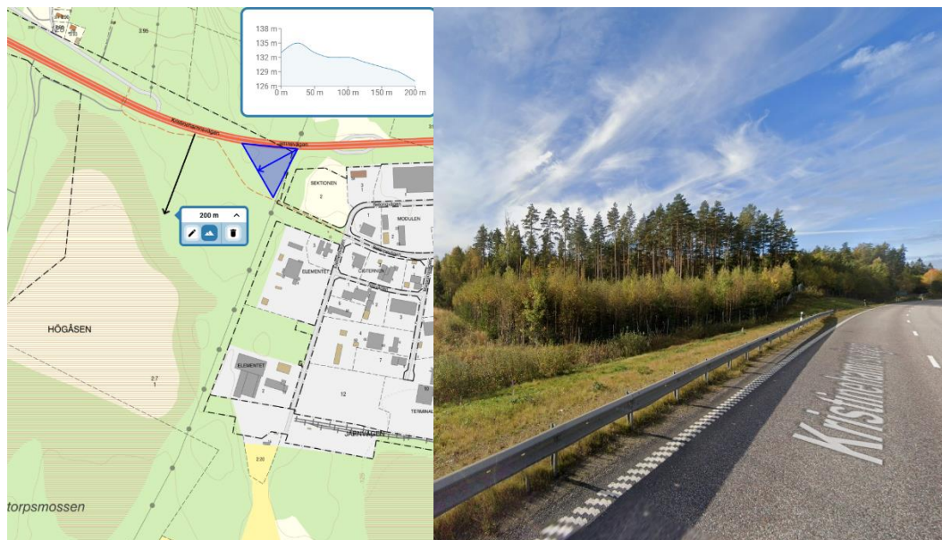
Figur 4-3. Till vänster: diagram med markhöjd på olika avstånd från väg E18, längst den svarta pilen, mätt vid detaljplanens mitt [8]. Svag lutning ned mot planerad bebyggelse kan utläsas, ca 5 höjdmeters fall över den uppmätta 200 meterssträckan. Blå triangel visar position och vinkel för vilken bilden till höger är tagen. Till höger: vyn från vägen mot planområdet, där viss uppförslutning skådas intill vägens västra del (till höger i bild), men med kuperad terräng i övrigt. [9].
