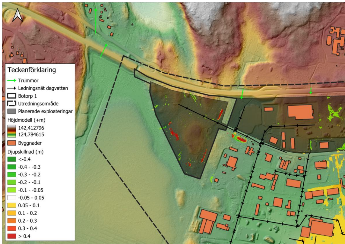
Figur 24. Skillnad i maximalt vattendjup i framtida situation med åtgärder jämfört med befintlig situation. Negativa värden (gröna nyanser i figuren) betyder lägre vattendjup i framtida situation medan gula/röda nyanser betyder högre vattendjup i framtida situation. Endast skillnader >5 cm visas i figuren.
