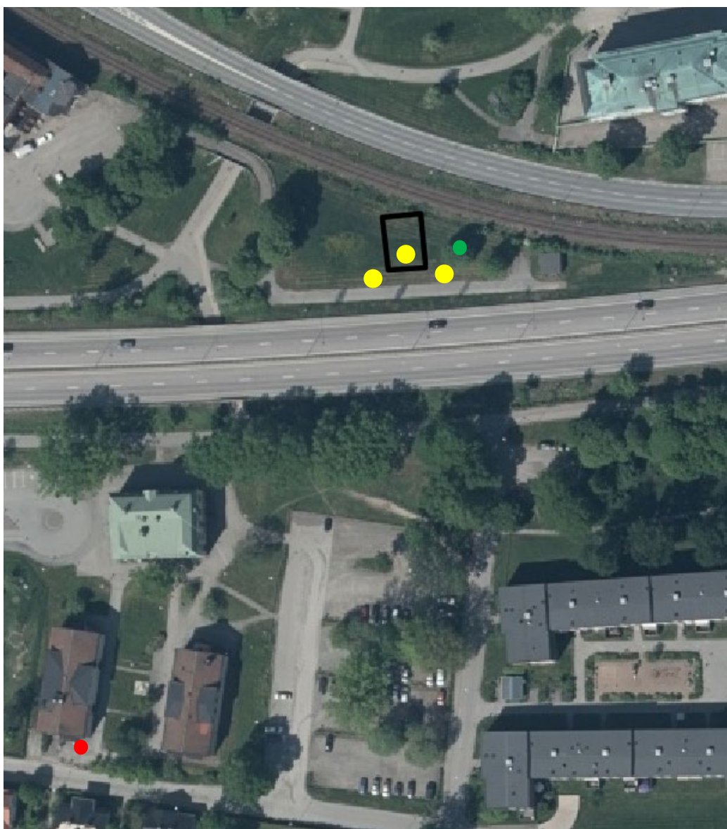
Figur 10. Provtagningsplan. Läget för Karlskoga tryckeri ungefärligt markerat med svart rektangel. Flygbild hämtad från Lantmäteriet, min karta. © Lantmäteriet. Trädprovtagningspunkt är markerad med grön punkt. Provtagningspunkter för provtagning av porgas är markerade med gula punkter och passiv provtagare är markerad med röd punkt.
